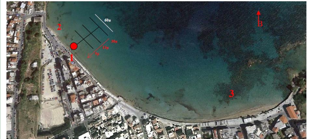
Εικόνα 1. Η παραλία Κουμ Καπί. Η εκροή του αγωγού βρίσκεται στο σημείο 1. Τα σημεία κολύμβησης των κατοίκων της περιοχής είναι τα σημεία 2 και 3. Μπροστά από την εκροή του αγωγού (σημείο 1) φαίνεται το πλέγμα των σημείων δειγματοληψίας στα 5μ, 15μ, 30μ.
